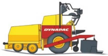
Il perno del telaio oscillante degli assi anteriori della finitrice gommata Dynapac presenta una disposizione asimmetrica. Questo tipo di sospensione consente la compensazione nei dislivelli che si incontrano durante la stesa. Le ruote motrici (di grandi dimensioni) sulla 3 assi fornisce la trazione richiesta per gestire
